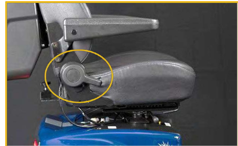
Figur 4 – Trekk i det svarte håndtaket for å justere ryggstøtten
