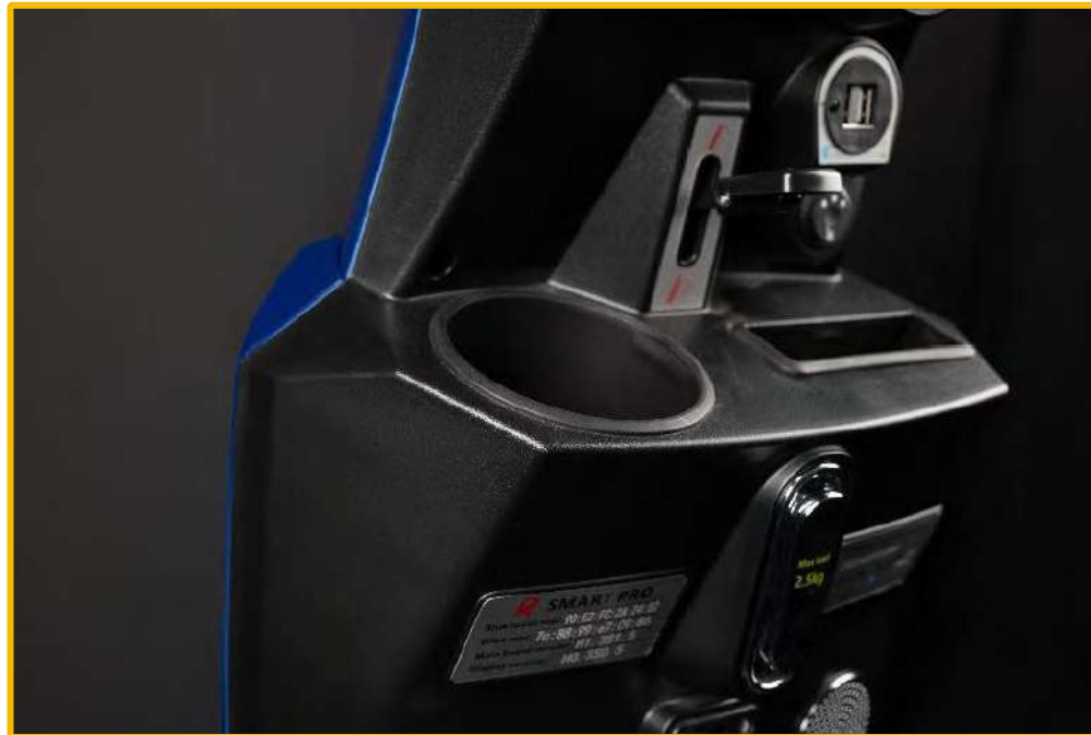
Figur 17 – Kopphållare och mobiltelefonhållare monterade på rattstången
