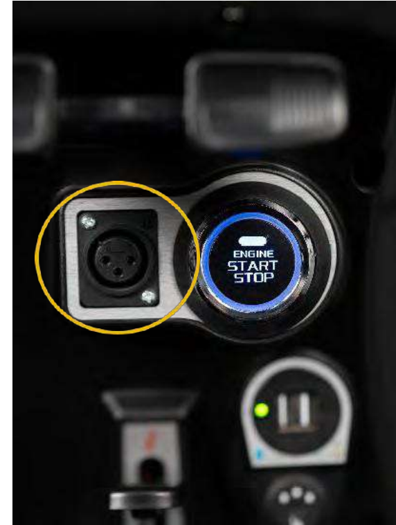
Figur 19 – Laddningsport monterad på styret
